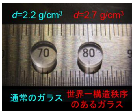
図 1 世界一構造秩序のあるガラス（右）と通常ガラス（左）
