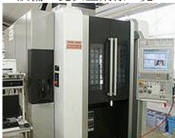
製造メーカー：DMG 森精機 株式会社 機種：5軸制御マシニングセンター 型番：NMV1500DCG 寄贈者：DMG 森精機 株式会社
