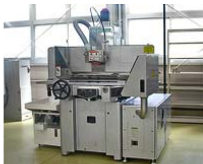
金型センター附属工場に設置された平面研削盤
