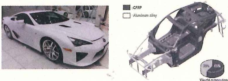
図9 CFRPを採用したスポーツカーや自動車用部品などの例
