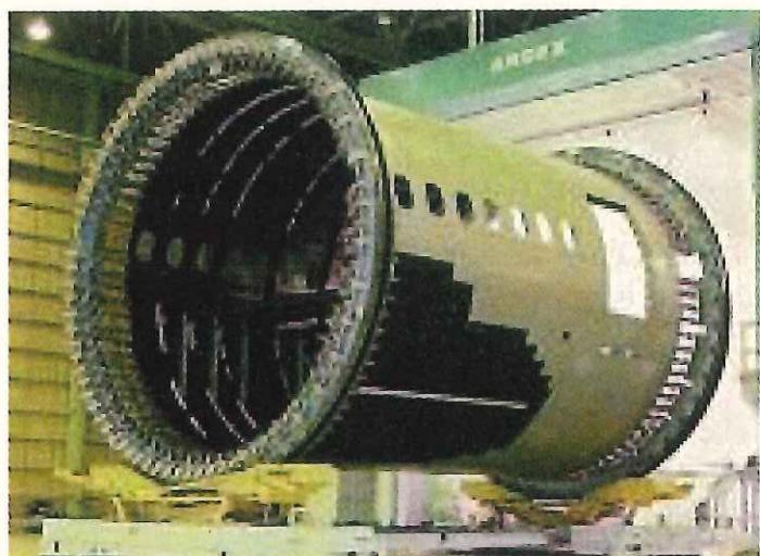
図8 航空機胴体の一体成型部品例
