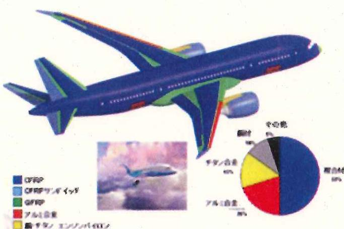
図2 B787に用いるCFRP
