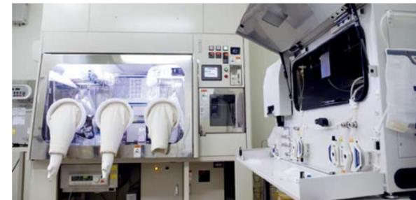
▲高度な無菌管理を行いながら細胞の処理工程が実施できる「セルプロセッシング・アイソレータ」(正面)と、小型の自動細胞培養装置(右)。▶平成25年秋に導入した最新の大型自動細胞培養装置。これにより、作業の大幅な効率化、感染リスク低減が可能に。
