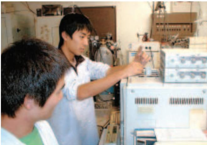
収穫後農産物の品質指標となる呼吸速度をガスクロマトグラフィーで分析します。
