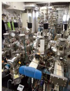
四層分離型薄膜シリコン太陽電池製造装置
