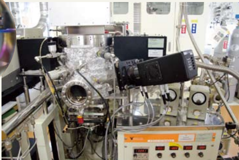
HIT太陽電池用プラズマ CVD薄膜シリコン成膜 装置
