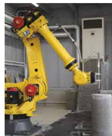
「産業用ロボット型3Dプリンタ」 独自開発のセメント材料を使用して柱の型枠を積層
