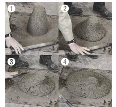
①は、物理ゲルの性能を持たせたフレッシュモルタル（コンクリートと同じくセメントを原料とした砂利を含まない材料）を、円錐形の容器に入れて静置したものを、容器を取り除いても円錐形のまま自立した状態を保つ。このフレッシュモルタルに振動を与えると、②→③→④のように徐々に円錐形の原形を留めなくなり、柔らかい液体のような状態となる。振動を止めれば、再び形状が保持される。
