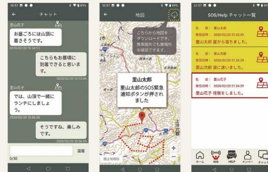
GEO-WAVE端末と接続したスマートフォンを使って、携帯圏外地域でも、チャット、位置情報、SOS信号の送受信が可能です。自分のいる場所を座標として送ることによって災害時の安全を確保するなど、さまざまな用途での活用が期待されています。
