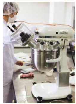
ミキサーに音響管とスピーカーを取り付け、ボウル内部の共鳴周波数を測定。ホイップクリームなどの体積の変化をかき混ぜながら計測し、きめの細かさなどを数値で確認できる。適切なタイミングで攪拌を止めることで、一定の泡立ちにすることが可能。
