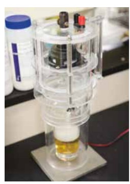
ビールの泡の質を測定する装置。音響共鳴法を活用すれば、ビールの泡のきめや泡立ち、さらには消費者の嗜好性を大きく左右する泡持ちなども計測が可能。企業の商品開発に役立てることができ、すでに飲料メーカーとの共同研究なども進めている。
