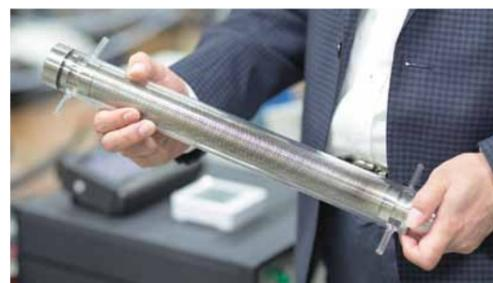
プラズマメンブレリアクターは二重構造になっており、外筒は石英ガラスを使用。内筒は穴の開いた薄い鉄板に、厚さ20マイクロメートルのパラジウム合金製の水素分離膜を溶接して、水素分離膜そのものをプラズマ発生用の電極としている。アンモニアを外筒と内筒の間に流し込み、電圧を加えてプラズマを発生させて水素と窒素に分離すると、水素原子だけが内筒の分離膜の表面に吸着して内部に透過し、さらに水素原子同士が結合して水素が生成される。製造された高純度の水素は、燃料電池に供給して発電することも可能。
