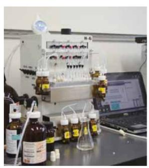
研究室に設置されたDNA-RNA自動合成装置。機能性分子の修飾だけでなく、天然のRNAの配列を変えて、治療薬に使いやすい安定的なRNAの合成を行っている。
