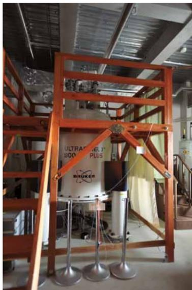
総重量10トンに及ぶNMR（核磁気共鳴）装置。800MHzと600MHzの2基を導入しており、タンパク質の立体構造を原子レベルで測定できる。
