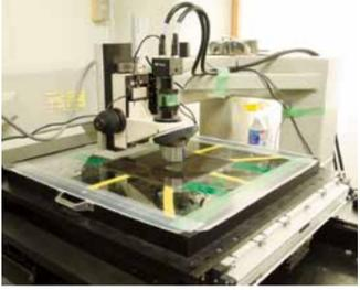
写真乾板の全面を自動で走査する光学顕微鏡。
