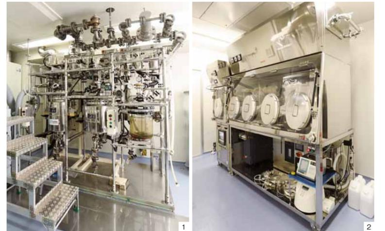
①平成27年に国内の大学で初となる点滴薬製造設備を導入。高温・高圧下で数十種類の有機化合物を合成して製薬できる設備で、大学として世界で初めてGMP (Good Manufacturing Practice、医薬品等の製造品質管理基準) に準拠した製造環境を整備し、無菌状態の設備内で分包ができるのが特徴だ。点滴薬製造設備や無菌調整のためのアイソレータ ②の導入により、ヤコブ病の進行を抑制する治療薬を大学内で製造することが可能に。当面、治験薬の製造は製薬会社に委託するが、将来的には医薬品の製造許可を申請予定。製薬メーカーではコスト面から創薬が難しい希少難病の薬の開発を進めていく考えだ。
