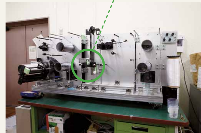
高分子ナノ多孔ファイバー製造装置 工学部化学実験・実習施設にある高分子ナノ多孔ファイバー製造装置。武野准教授が設計から手掛けたオリジナルの装置で、毎分10mの速度でナノ多孔ファイバーを製造できる。
