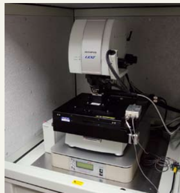
ごく細い探針を使うことで、太陽光パネルの局所的な特性を評価する「光起電力顕微鏡」。
