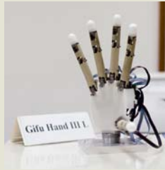
複雑多様で器用な操作ができる人間型ロボットハンド「Gifu Hand」。人間の指関節と同じ関節数と自由度を持つ。平成18年度文部科学大臣表彰受賞
