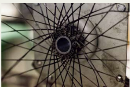
複合材料センター内にある組物作製装置。左右、内外に円を回して炭素繊維とプラスチックを四角や丸状に組み上げる。
