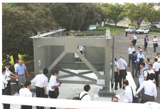
写真-2 鋼桁端部モデル
