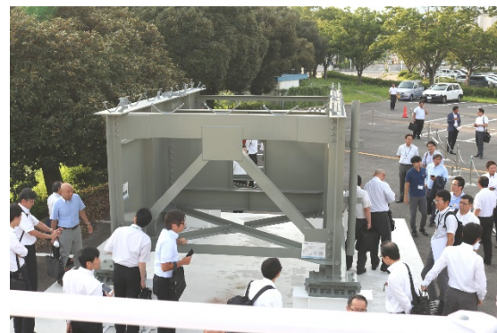
写真-2 鋼桁端部モデル
