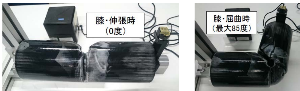
写真4. 岐阜大学工学部 松下光次郎助教による性能評価試験装置(伸張時、屈曲時)
