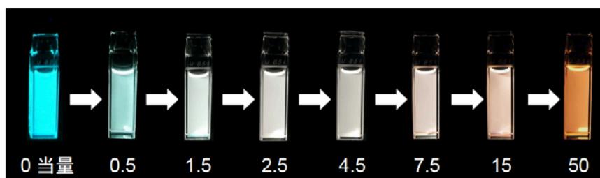
図1、青色の蛍光発光化合物に、酸を加えた時の発光色の変化 始めの青色が徐々に薄くなって、およそ3当量加えた時点で白色になり、さらに酸を加えると橙色に変化している。
