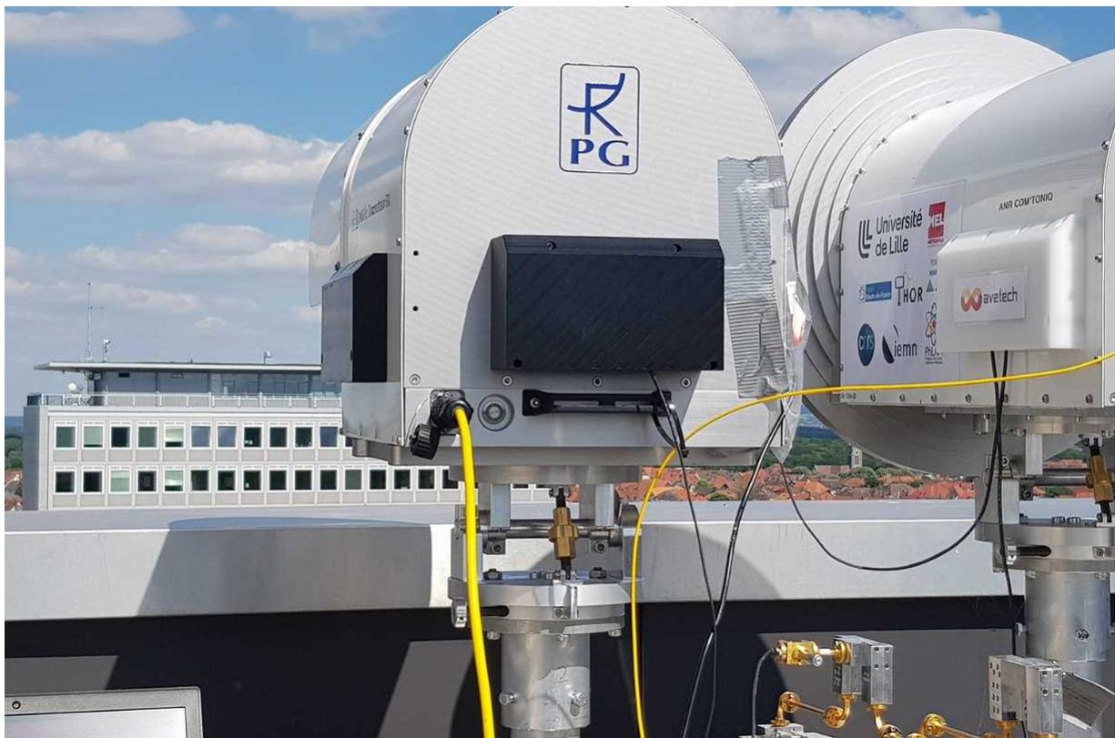
図 1：ブラウンシュヴァイク工科大学構内の Oker Tower と IT センター(距離 160m)を結ぶ無線装置
