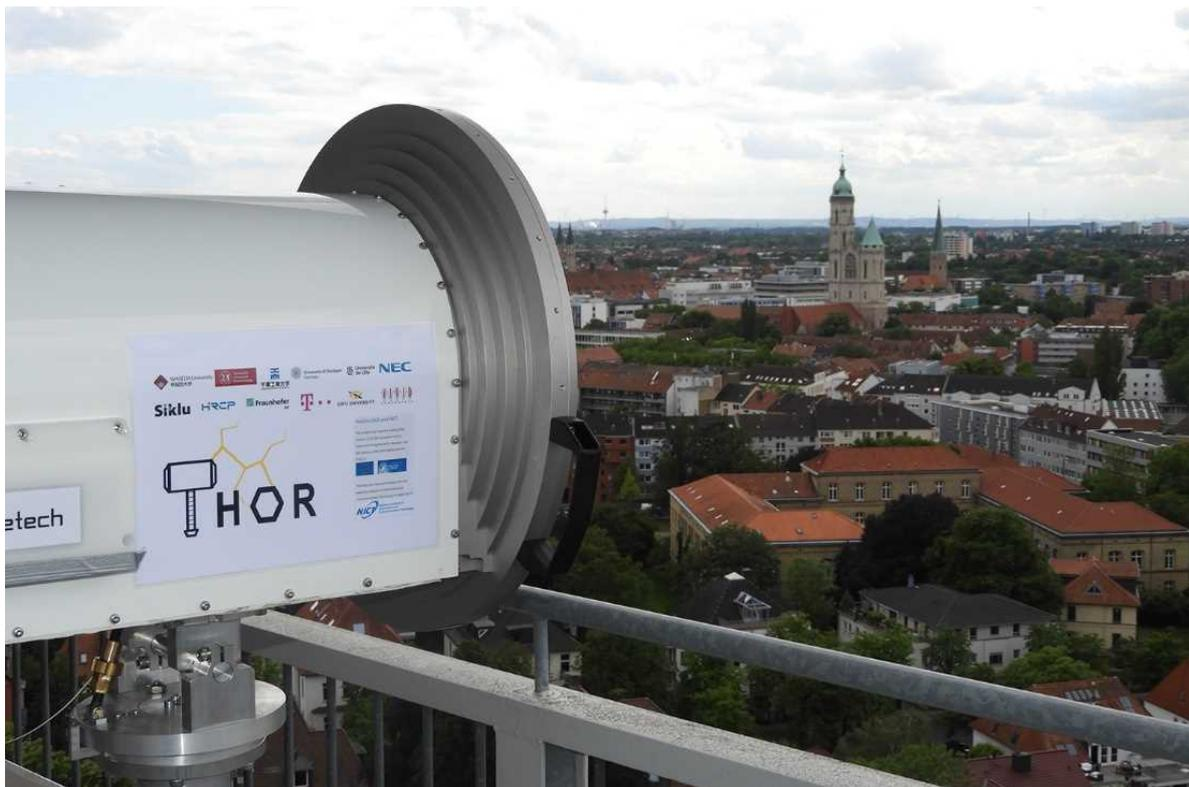
図2：ブラウンシュヴァイク工科大学構内建物屋上に設置された世界初の実データ伝送可能な双方向テラヘルツ無線装置
