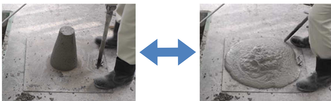
写真1: 物理ゲル性能を付与したフレッシュモルタル
