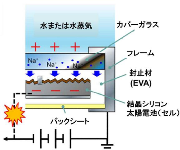
図2: 太陽電池モジュールに挿入した液体ガラスにより作製したガラス層の配置
